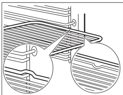
Rošt vložte mezi vodící lišty drážek roštů a ujistěte se, že nožičky směřují dolů. Ujistěte se, že se rošt dotýká zadní strany vnitřku trouby.
