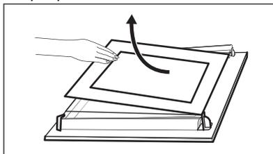
8. Sklenené panely umyte vodou s prídavkom saponátu. Sklenené panely dôkladne osušte. Sklenené panely neumývajte v umývačke riadu.
