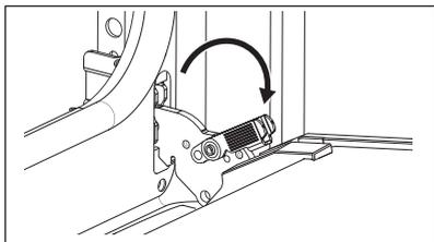
3. Napůl přivřete dvířka trouby do první polohy otevření. Pak dvířka nadzdvihněte a vytáhněte z jejich umístění.
